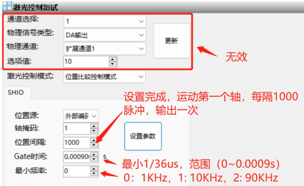
根据以上配置，点击【更新】→【设置参数】，根据轴掩码选择，启动相应轴运动，对应引脚会有 DA 输出;此功能不能与 [菜单栏→功能→其他资源\(辅助编码器等\)](#) 一起打开测试，否则需要复位控制器;
