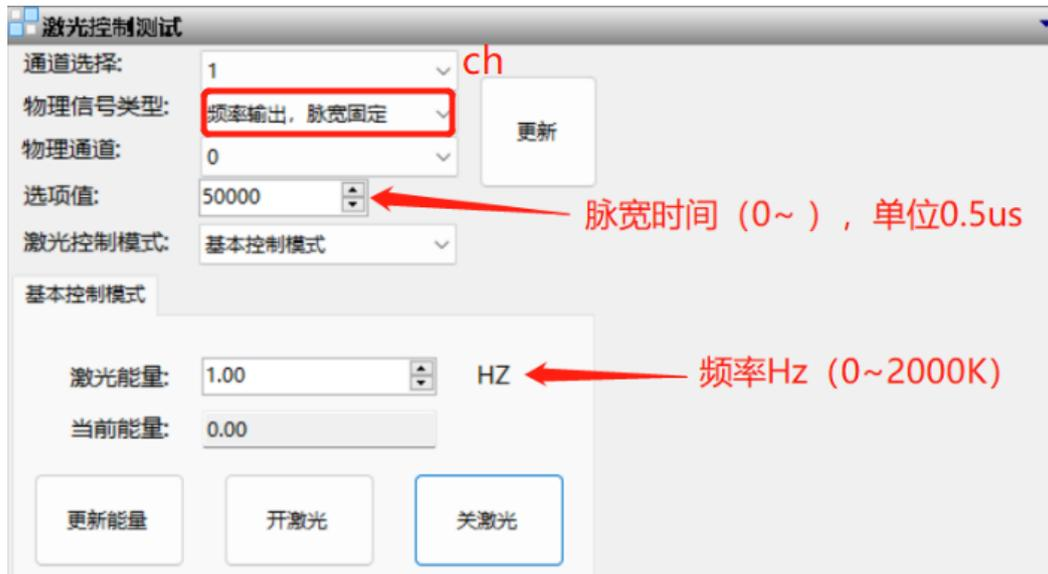
根据以上配置，点击【更新】→【更新能量】→【开激光】，对应引脚会有 PWM 输出；此功能不能与 菜单栏→功能→其他资源(辅助编码器等)一起打开测试，否则需要复位控制器；
