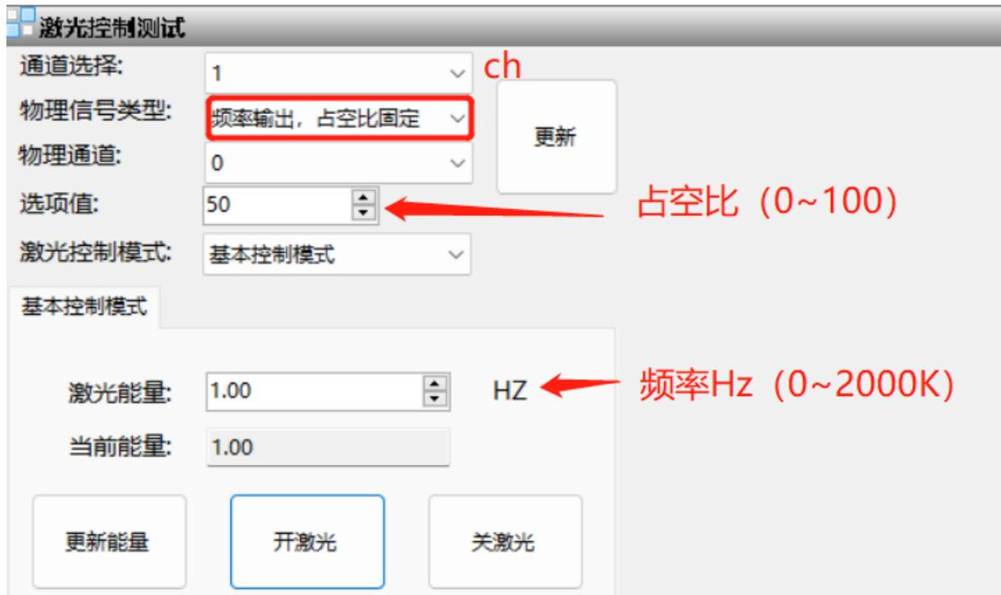
根据以上配置，点击【更新】→【更新能量】→【开激光】，对应引脚会有 PWM 输出；此功能不能与 菜单栏→功能→其他资源(辅助编码器等)一起打开测试，否则需要复位控制器；
