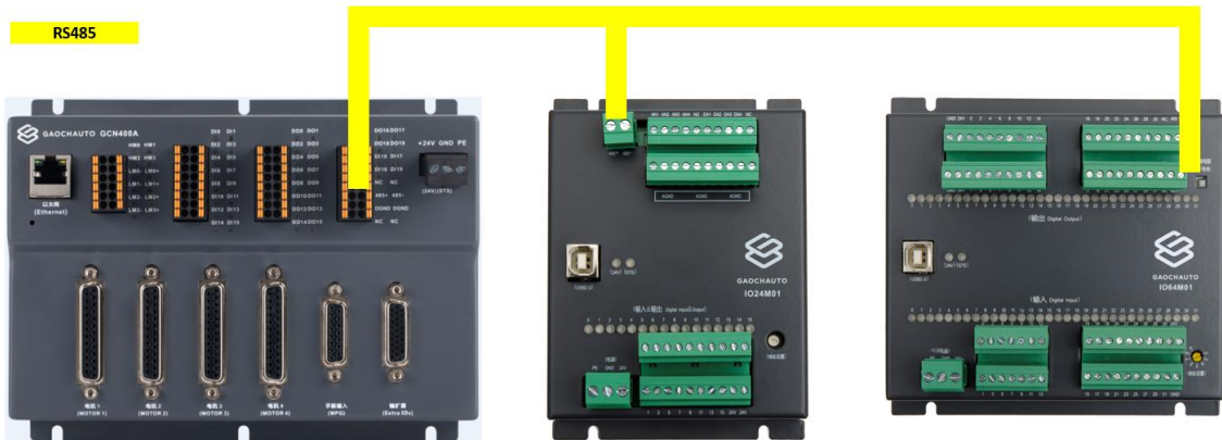
图 2.1.1 IO 模块接线示意图
